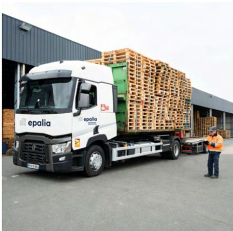
La hauteur de chargement est importante, elle doit être de 3,10 mètres maximum
